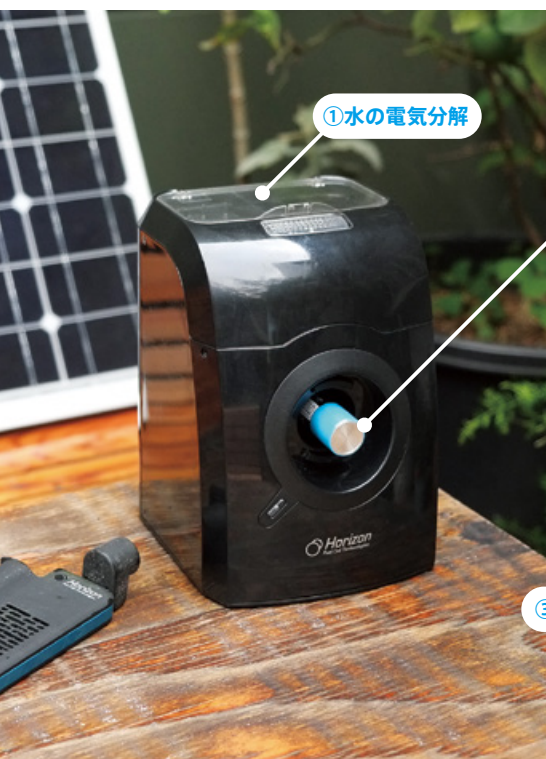
↑イワタニ水素ステーション芝公園。↓携帯電話などの充電に使える、Horizon Fuel Cellの燃料電池製品。水素をつかって、貯めて、使う、R水素の仕組みを体験できる。
