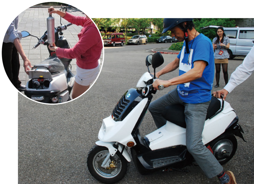
台湾で開発された燃料電池スクーター。水素の充填は、水素吸蔵合金のカートリッジを交換して行う。水素 45g のカートリッジ 2 本で約 80km 走行可能。
