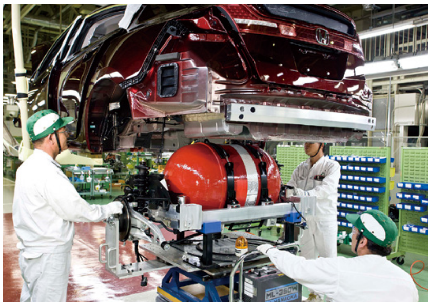
ホンダの燃料電池自動車「FCX クラリティ」に水素タンクを搭載する様子。(2008 年 6 月)
